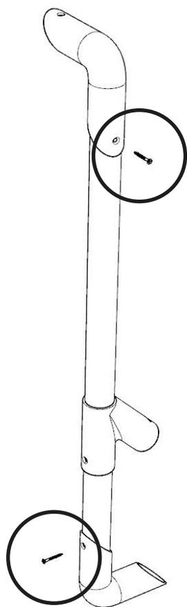
Fissare i due pezzi B con viti utilizzando gli appositi fori di fissaggio presenti nel pezzo
